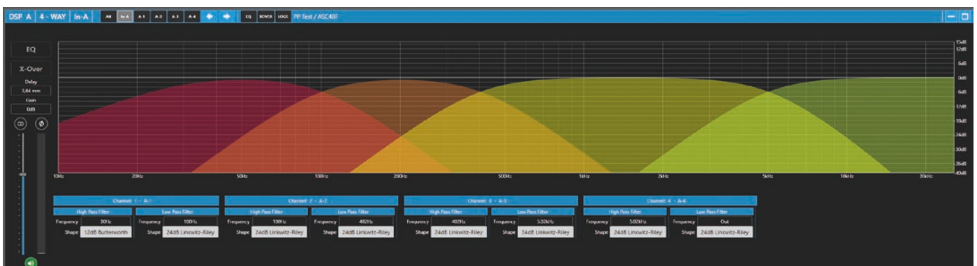
Übersicht zu den eingestellten X-Over-Filtern am Beispiel eines 4-Wege-Systems (Abb. 22)
